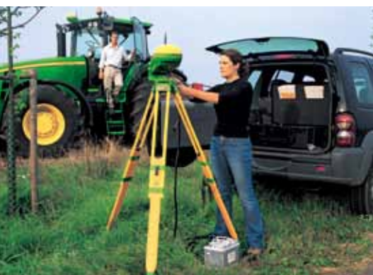
Eine eigene Referenzstation steigert die Genauigkeit der Positionsberechnung.
