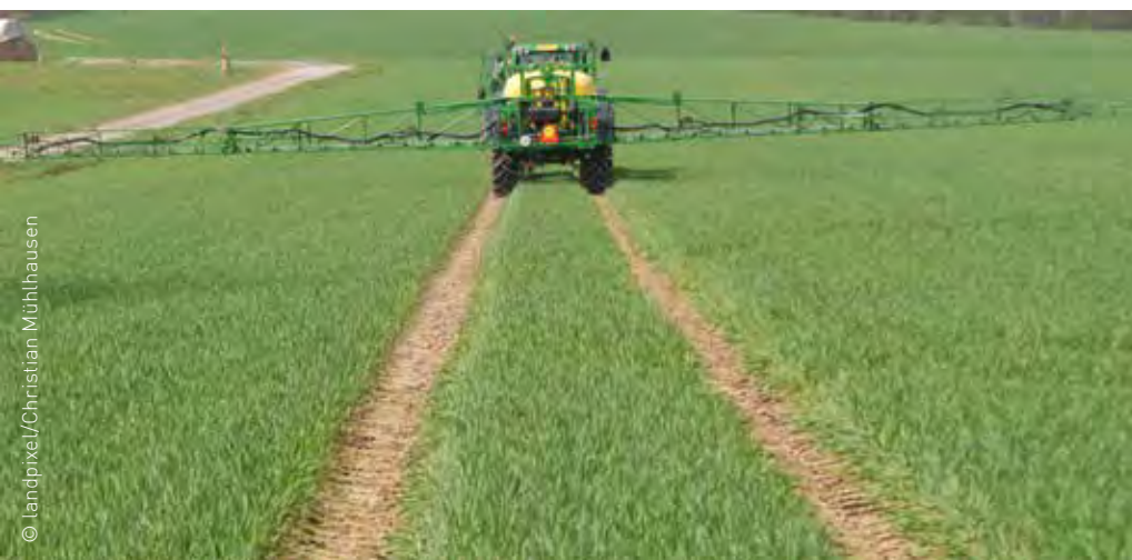
Randdüsen außen an den Spritzgestängen helfen beim Einhalten der Abstandsauflagen und an der Fahrgasse beim Einsparen von Mitteln.
