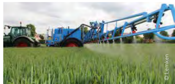
Je nach Situation auf dem Feld werden am Gestänge ganz unterschiedliche Düsen montiert, teils auch Rohre oder Schläuche für die Unterblattspritzung oder Bodenausbringung.
