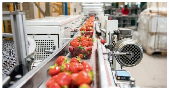
Auf dem Weg in und aus dem Lager oder in die Verarbeitung erkennen Sensoren beschädigte Früchte (z. B. Äpfel) und sortieren sie aus. Die Packstraßen können auch wiegen, z. B. Erdbeeren für 500 g-Schalen.
