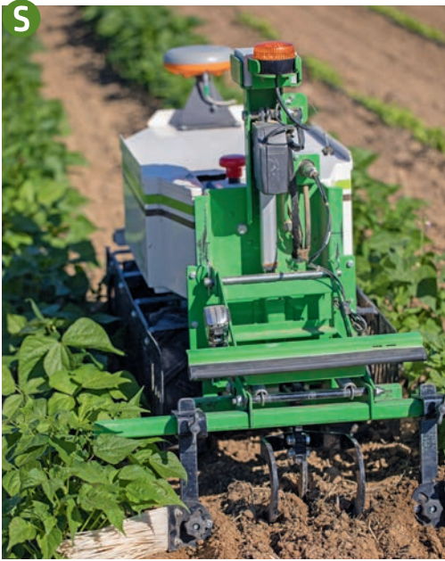
Der Roboter „Oz“ unterstützt bei der oft eintönigen Arbeit des Hackens.
