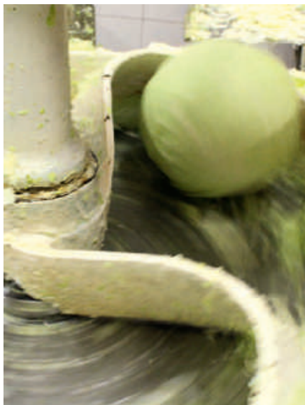
Ein rotierendes Messer hobelt den Kohl in feine Streifen.
