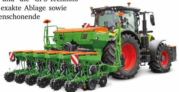
Aussaart zu gewährleisten. Die Vorteile dieser Methode sind eine bessere Licht- und Nährstoffnutzung sowie eine effizientere mechanische Unkrautbekämpfung. Allerdings ist die Einzelkornsaat aufwendiger und teurer als die Drillsaat. Moderne Technologien optimieren beide Verfahren weiter und tragen zur Effizienzsteigerung in der Landwirtschaft bei.
